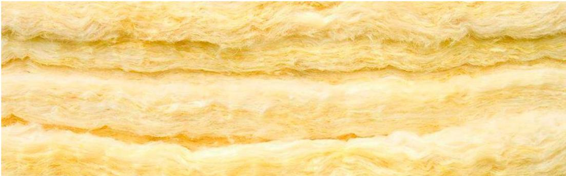
La lana de roca es ignífuga e incombustible (A1), hidrófuga y porosa, por tanto actúa como aislante acústico. Una vez insuflada, la lana mineral queda totalmente compactada en el interior de la cámara, a una densidad de 70 kg/m<sup>3</sup> +- 20 kg/m<sup>3</sup>. Es el único material que cuenta con los certificados necesarios para subvenciones en España.
