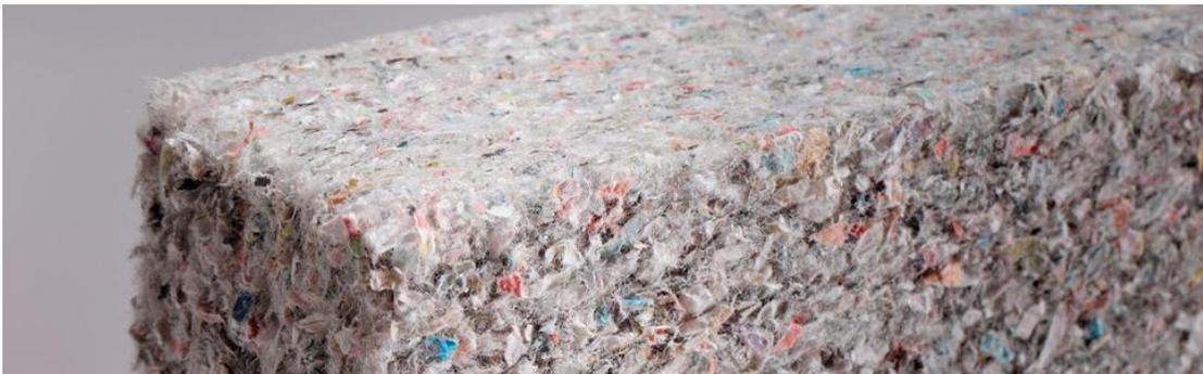
Se insufla simplemente realizando una perforación o proyectándolo, no es necesario por tanto un andamiaje o una gran obra de renovación de fachada, como las antiguas proyecciones de poliuretano. Otra ventaja fundamental que tiene este material es que se distribuye homogéneamente en todos los huecos, evitando juntas y zonas que se quedan sin aislar, evitando así las humedades intersticiales y los puentes térmicos.
